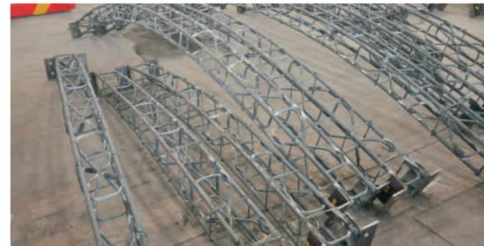
600MP级主筋高强度格栅拱架
